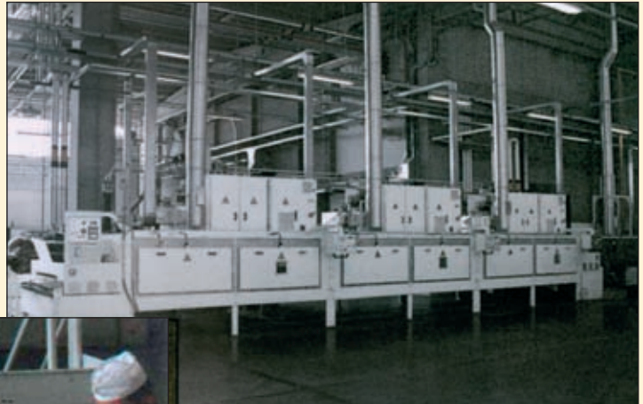
Impianto "RF 3x60 kW" per il trattamento post-forno di panetti croccanti. "RF 3x60 kW" equipment for the post-baking drying of crispbread.
