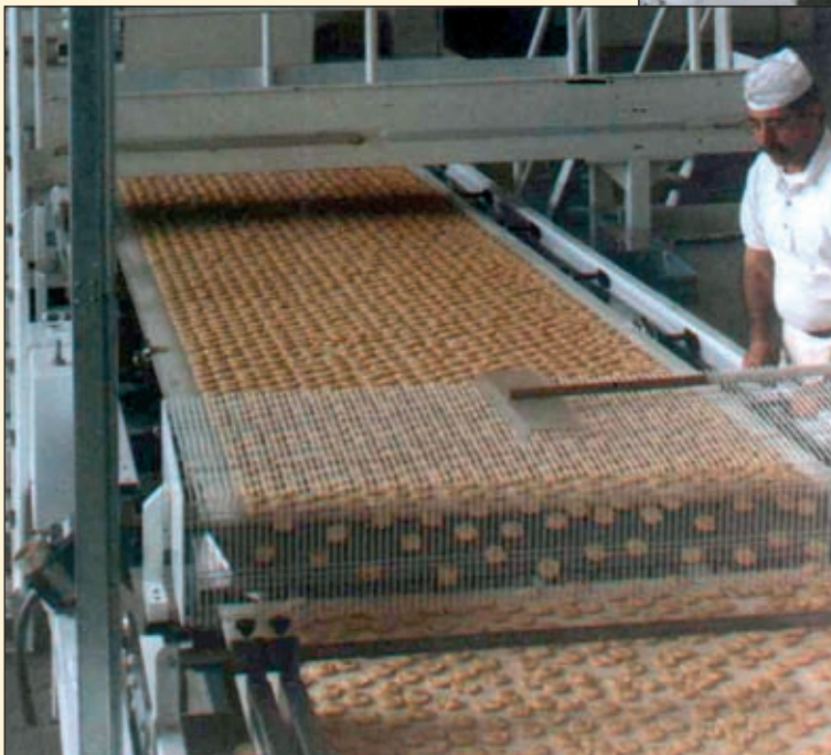
Impianto "RF 3x60 kW" per il trattamento post-forno di panetti croccanti. "RF 3x60 kW" equipment for the post-baking drying of crispbread.
