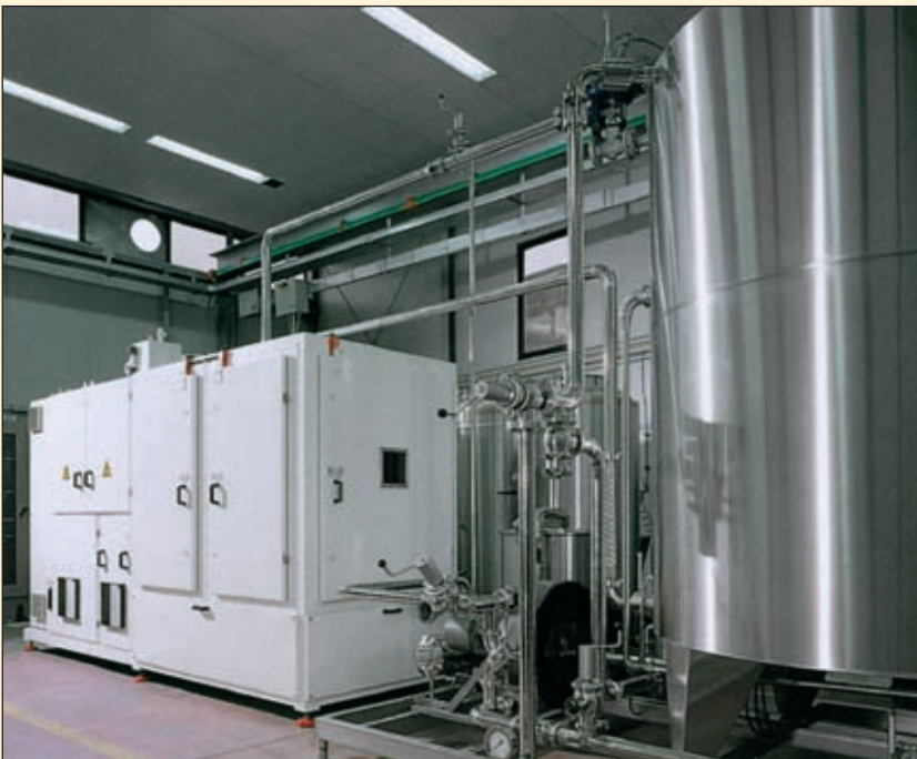
Impianto "RF/L 70 kW" per la sterilizzazione in continuo di polpa di frutta.
